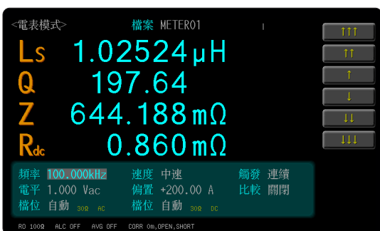
對電感施加200A，電感量降至1.02 \mu\text{H}
