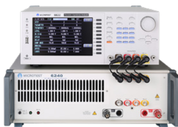
頻率 VS DC偏流掃出電感的飽和頻段
